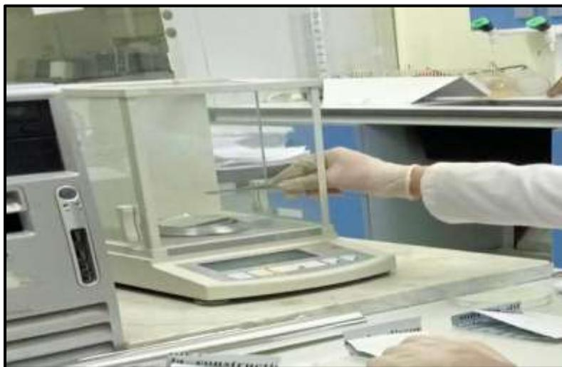
**Figure 35.** Mensuration du poids des oreilles avec une balance de précision.
